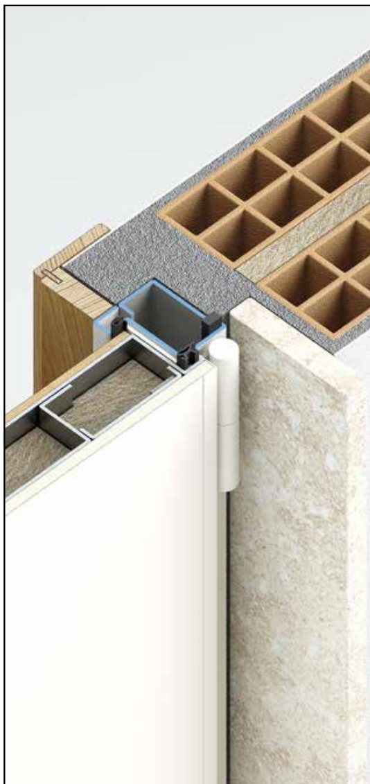
Cassamatta : KB, rifinitura muro interna con coprimazzetta in legno, esterna con vecchio stipite in marmo.
