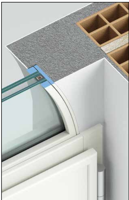
Particolare : sezione dell'arco piatto di soli 20 mm rispetto ai 65 mm del telaio normale.
