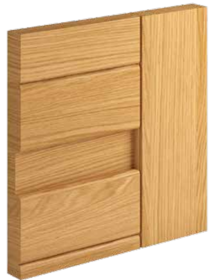
247 Spessore pannello 21 mm. Fresa raggio 5 mm con fascia in depressione di 11 mm.
