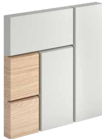
218-224-660 Spessore pannello 21 mm. Fresa a "V" larghezza 7 mm e profondità 12 mm.
