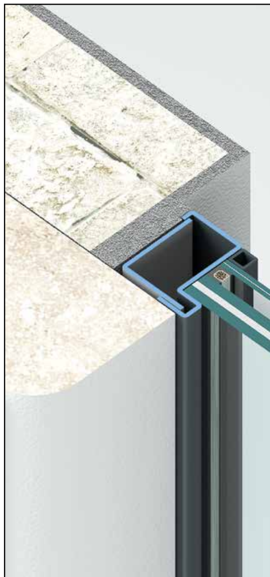
Cassamatta : KC1, rifinitura muro interna ad intonaco, esterna con portale in pietra esistente.
