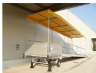
Tettoia di copertura superiore in PVC con telaio e parapetti
