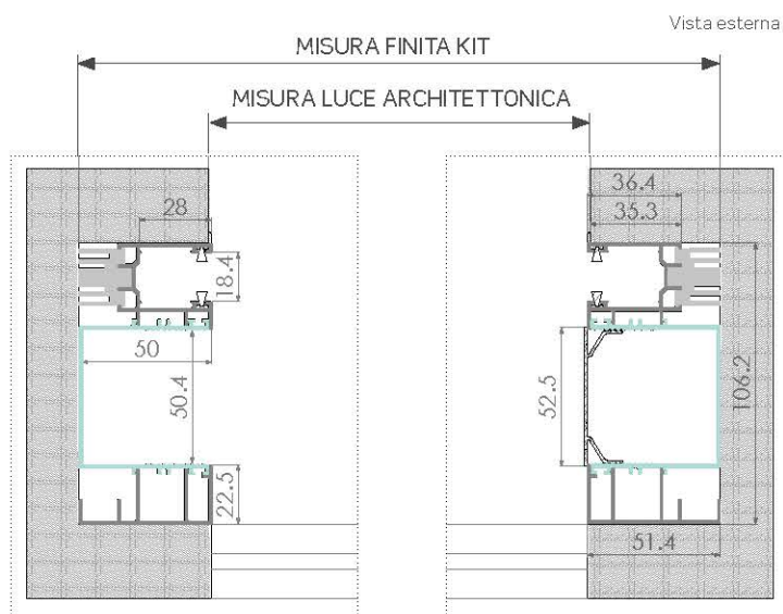
SEZIONE ORIZZONTALE Vista interna
