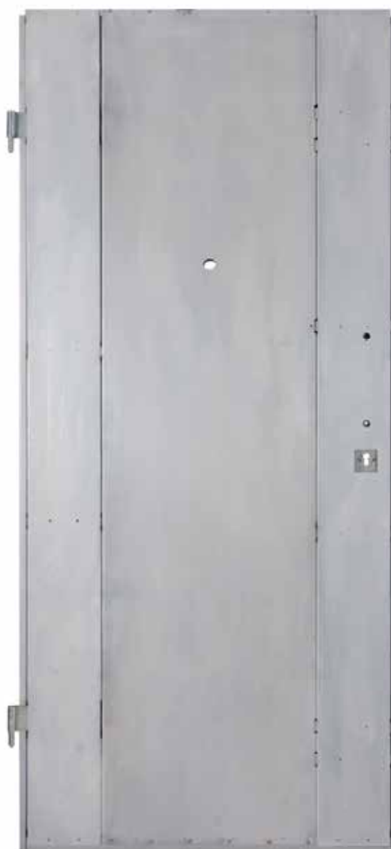
Scocca modello OBELIX con doppia lamiera laterale, obbligatorio su porte con larghezza superiore a cm 100.
