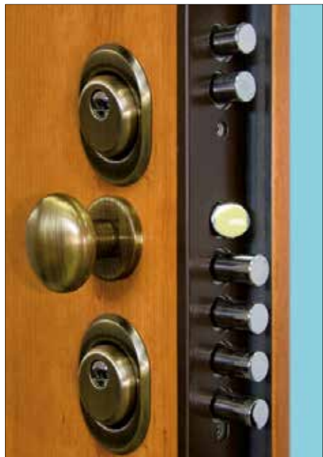
SERRATURA EUROPEA 28/63 ad ingranaggi con SERRATURA DI SERVIZIO, comanda i 2 chiavistelli superiori e lo scrocco, blocca la serratura principale.
