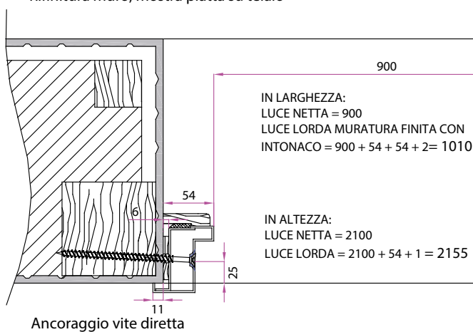
Rifinitura muro, mostra piatta su telaio
