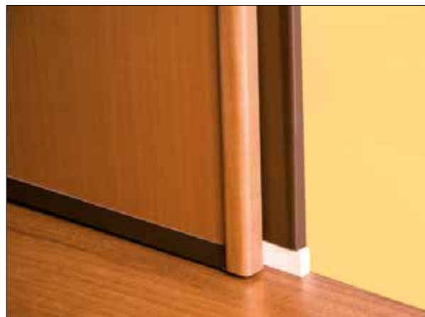
BATTUTA SOTTO OLTRE LUCE è indispensabile che la soglia in marmo sporga internamente di cm 1 (vedi schede tecniche pag. 227).
