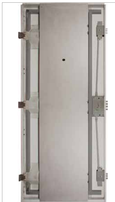
6- Chassis rinforzo 35x35x2 mm interno alla struttura. Serve a dare rigidità alla porta blindata ed a preservare i punti di chiusura nel momento della forzatura.
