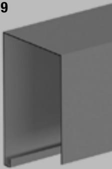
**VELETTE DI COPERTURA CON SPESSORE 12/10, DA 200 A 400 MM DI ALTEZZA, IN ALLUMINIO VERNICIATO CON TAPPI LATERALI E GIUNTI A RICHIESTA.**
