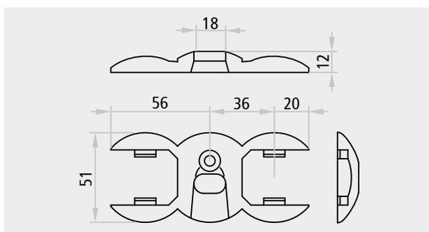
Boccola inferiore per anta passiva FREEEV
