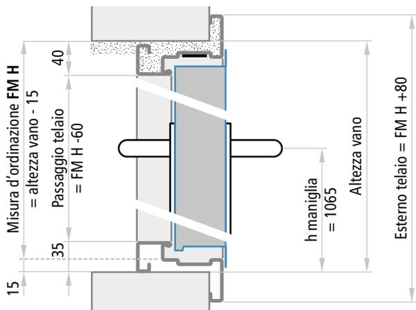
**Porta ad un'anta con telaio su quattro lati e anta senza battuta inferiore**
