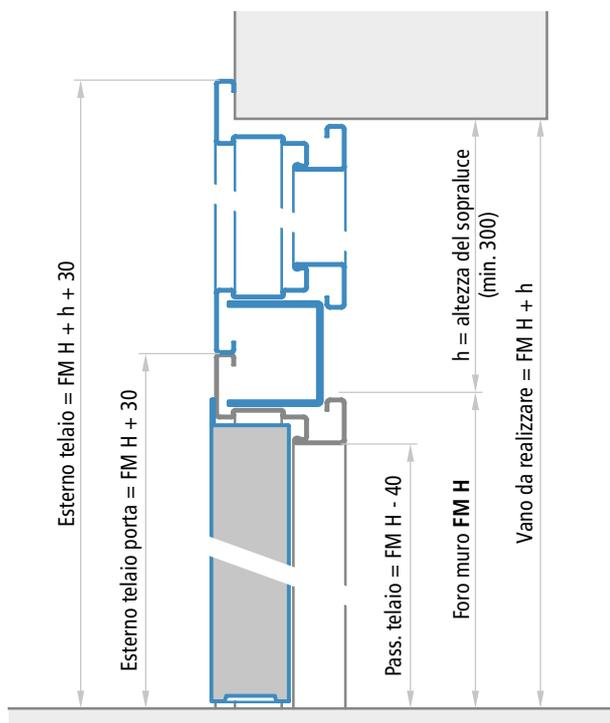
sezione della porta con sopraluce e telaio angolare (standard)
