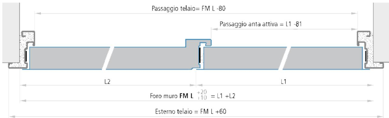
**Porta ad un'anta con telaio su quattro lati e anta con battuta inferiore**
