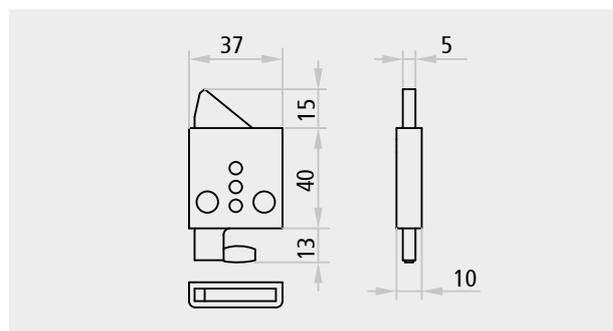
Dispositivo superiore per anta passiva FREEGET e altre multiuso
