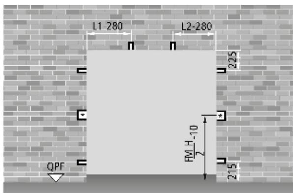
(\*) scassi da realizzare di sezione 200 x 160 mm.
