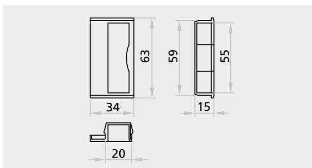
Inserto di riscontro serratura per porta ad una anta FREEGET e altre multiuso
