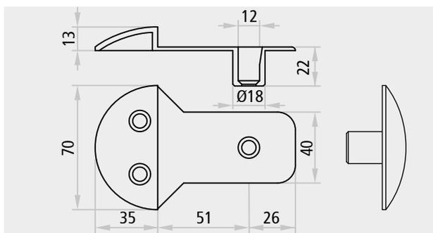
Boccola inferiore per anta passiva FREEGET e altre multiuso
