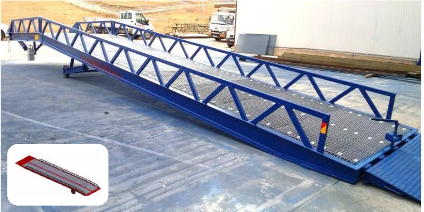
La RAMPA DA PIAZZALE in ferro rappresenta l'ALTERNATIVA ECONOMICA alla rampa da piazzale in alluminio. È dotata di un sistema di regolazione altezza manuale a pompa idraulica, di parapetti anticaduta mezzo e catena ruote di spostamento + golfaro posteriore. La finitura del telaio è in acciaio verniciato e la superficie di passaggio aperta è in acciaio grigliato.
