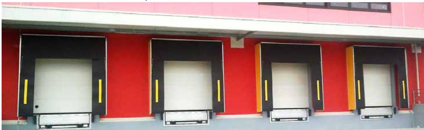
I portali isotermici a patelle versione hanno una struttura portante innovativa in estruso d'alluminio, LEGGERA, RESISTENTE E PIÙ SEMPLICE DA MONTARE ED INSTALLARE (vedi manuale uso), telo perimetrale in pvc autoestinguente e patelle frontali di isolamento in pvc resistente anti-strappo a doppia telatura. Disponibili anche in versione h 4500mm per installazione a livello stradale.
