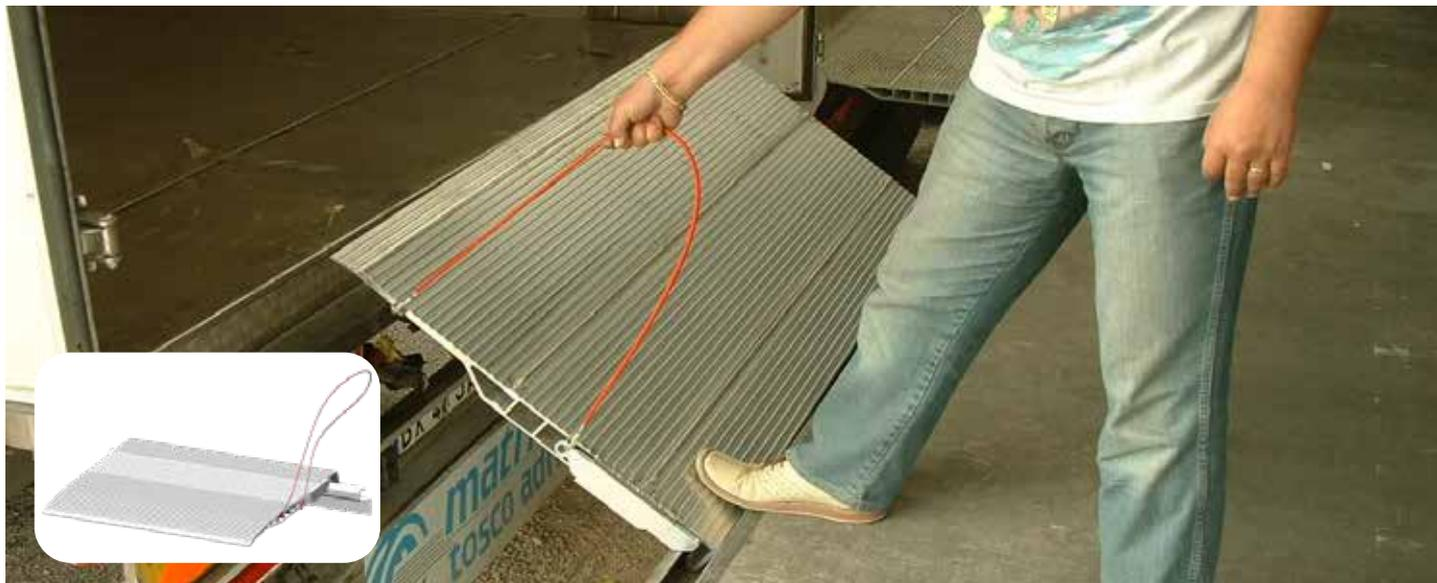
Le pedane manuali traslabili hanno un semplice sistema di traslazione A GANCIO, in grado di adattarsi facilmente anche in situazioni di carichi leggermente pendenti. Per contro, il sistema è studiato PER MEZZI A RUOTA GRANDE (MULETTI CABINATI) e NON PER TRASPALLETS-MEZZI A RUOTA PICCOLA.
