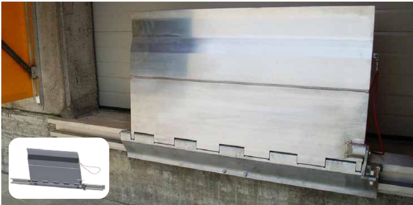
La pedana manuale traslabile in alluminio è stata progettata con un PERFORMANTE SISTEMA DI SLITTAMENTO SU CUSCINETTI, costituito da un estruso con i cuscinetti a sfera sottostanti INCERNIERATO AL PIANALE, in questo modo la pedana risulta PIU' ADERENTE A BORDO BANCHINA ED ADATTA ANCHE PER MEZZI A RUOTA PICCOLA, inoltre la traslazione a cuscinetti consente lo SCORRIMENTO SU DISTANZE MAGGIORI, RIDUCENDO IL NUMERO DI PEDANE PER BAIE DI CARICO.
