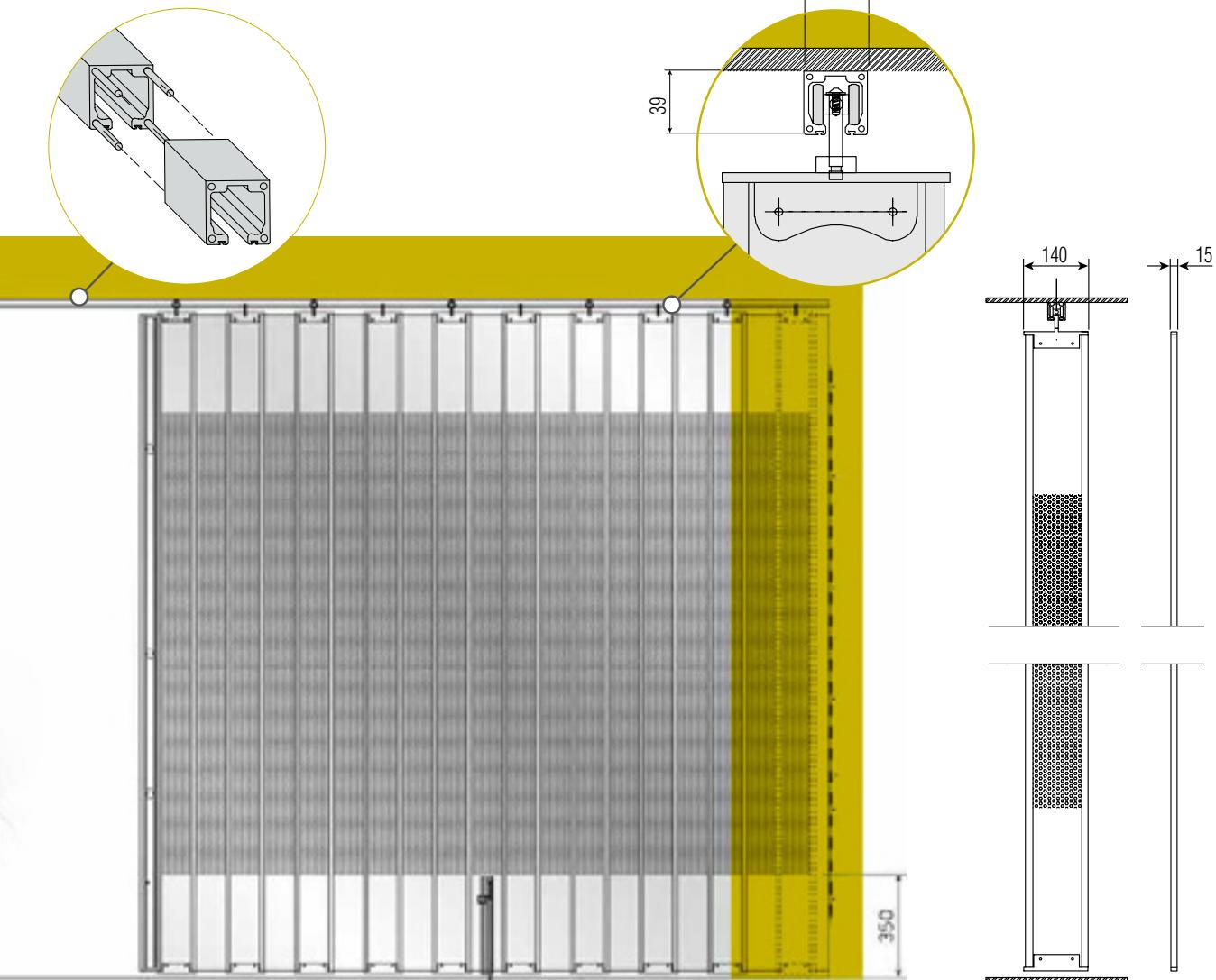
**Profili in alluminio estruso permettono l'alloggiamento delle serrature e consentono la precisa e sicura controbattuta**
